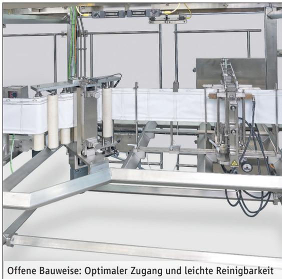
Offene Bauweise: Optimaler Zugang und leichte Reinigbarkeit
